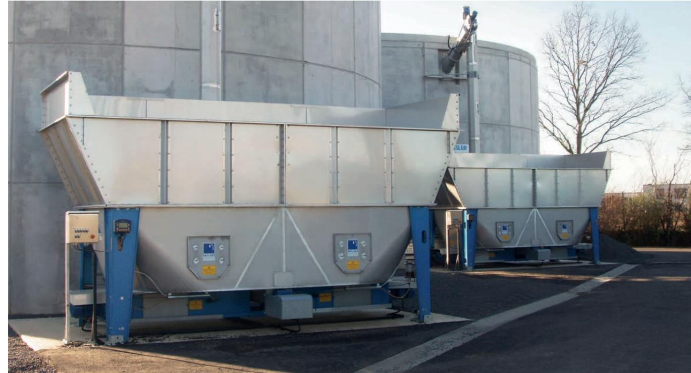
Feststoffdosierer Typ 300 mit 3-teiligem Schneckenstrang Typ 360
