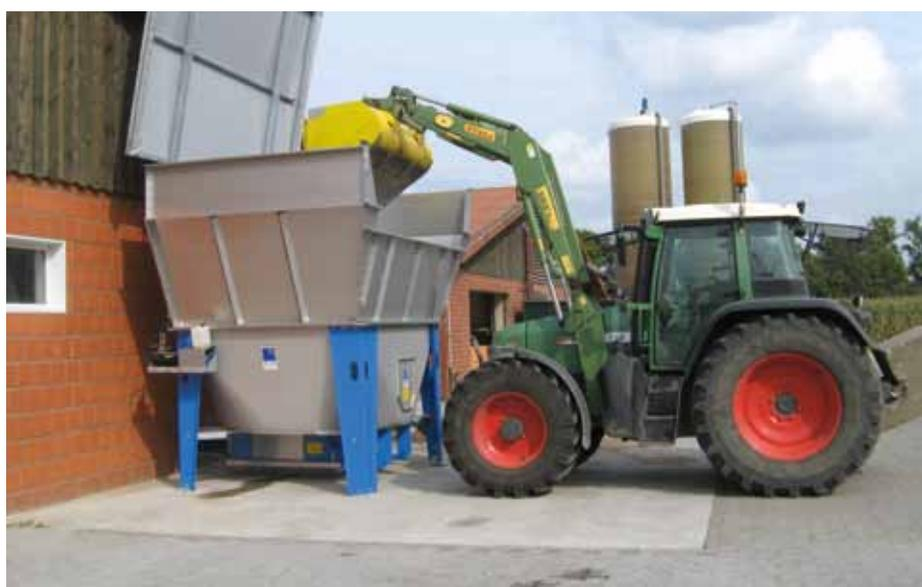
Dosierer Typ 200 mit 20 m<sup>3</sup> Lagervolumen, Entnahmeschnecke Typ 160 und hydraulisch betätigtem Deckel
