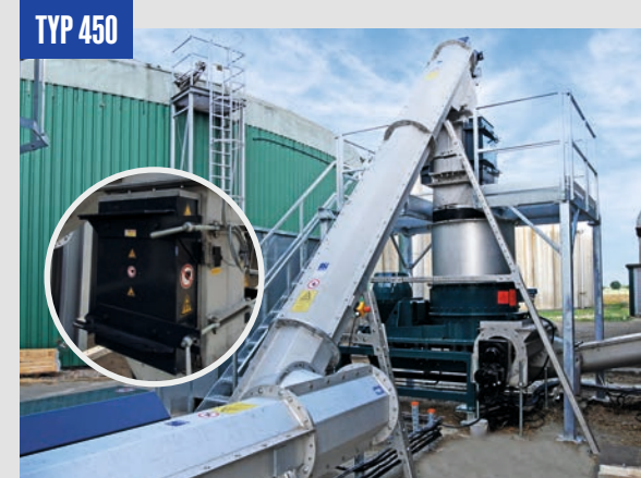
Ein zweiteiliges Förderschneckensystem bestehend aus einer Unterbau- und Schrägförderschnecke TYP 450 mit Magnetabscheider übergibt das Substrat an einen Vertikalzerkleinerer.
