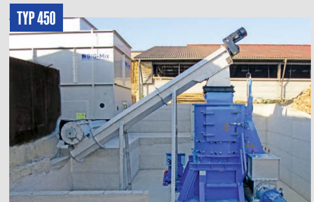
Ein zweiteiliges Förderschneckensystem TYP 450 bestehend aus einer Unterbau- und Schrägförder-schnecke beschickt einen Vertikalzerkleinerer. Die Fördermenge wird individuell an das Leistungsniveau des nachgeschalteten Vertikalzerkleinerers und den angestrebten Zerkleinerungsgrad angepasst.
