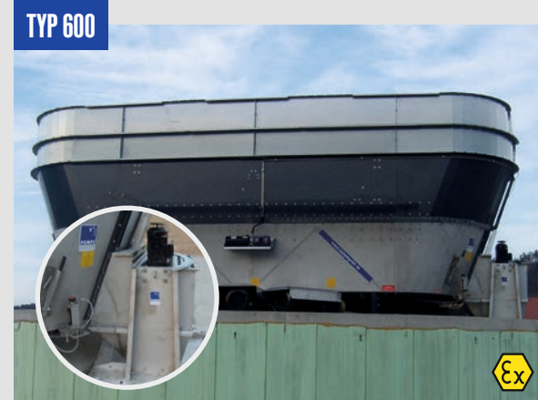
Die Fermenterschnecke TYP 600 mit senkrechtem Ein-trag nach ATEX beschickt direkt den Fermenter. Der Feststoffdosierer übergibt das Substrat in die Fermenter-schnecke über eine hydraulische Schieberöffnung.
