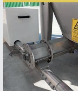
Für einen störungsfreien Betrieb wird ein rotierender Auswerfer eingesetzt. Diese Übergabe mit Gebrauchsmusterschutz sorgt für eine reibungslose Zufuhr der Faserstoffe von der Unterbauschnecke auf die Rohrförderkette. Bis zu vier Rohrförderketten können so mit dem Dosierer beschickt werden.
