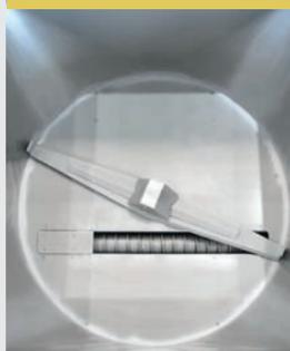
Elementarer Bestandteil des UNI-Dos Raufutter ist die bewährte Bodenentnahme. Im Inneren des Behälters befindet sich ein doppelarmiges Dosierschwert. Dieses rotiert über dem kreisrunden Bodenblech und beschickt eine waagerechte Unterbauschnecke. Die Drehzahl/Fördermenge kann dabei mit einem Frequenzumrichter verändert werden.
