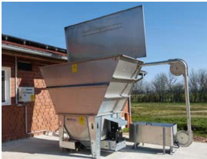
Bei Platzmangel kann die Uni-Dos-Anlage mit einem Deckel ausgestattet und so im Freien aufgestellt werden.
