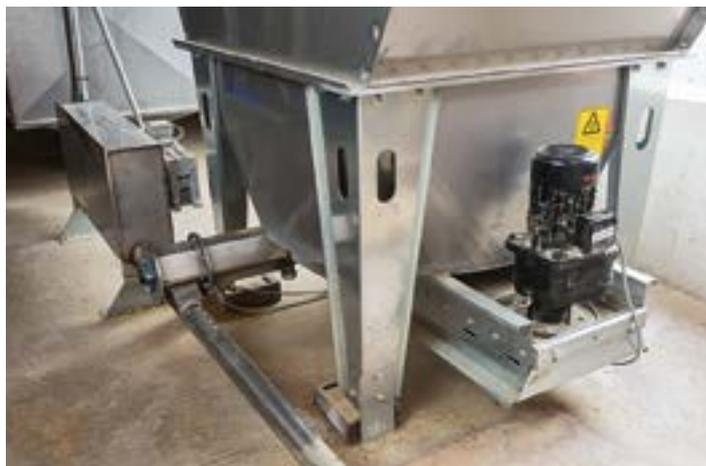
*Am Boden des Vorratsbehälters rotiert ein Schwert. Es sorgt für eine gleichmäßige Beschickung der untergebauten Zuführschnecke.*
