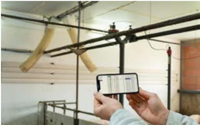
Bei der Variante mit Einzelventildosierung können die Stroh-mengen per Handy kontrolliert und angepasst werden. Fotos: Hersteller (3), Tovornik
