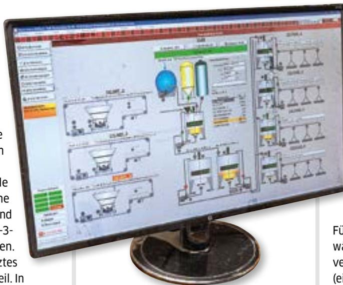
Die Uni-Dos-Vorratsbehälter werden zusammen mit der Fütterungsanlage auf dem Dashboard von Meyer-Lohne angezeigt.
