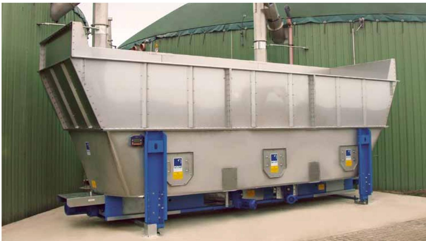
Doseur de matières solides, type 500 avec lignes de convoyage en continu à 3 pièces, type 360, pour l'alimentation de deux digesteurs
