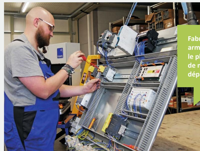
Fabrication d'une nouvelle armoire de contrôle selon le plan de commutation et de montage de notre propre département électrique.
