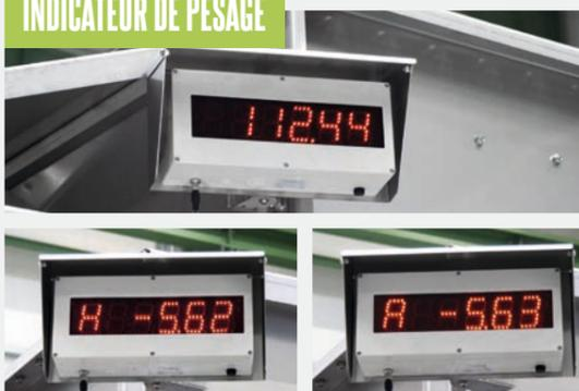
Un écran LED avec un affichage bien visible vous donne des informations sur le poids rempli de l'installation. Comme pour le panneau web, l'affichage LED du système de pesage est protégé par un capot de protection contre les intempéries en acier inoxydable et peut également être positionné à un endroit convivial de votre installation.
