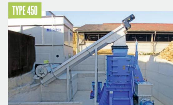
Un système de vis d'alimentation en deux parties TYP 450, composé d'une vis de base et d'une vis d'alimentation inclinée, alimente un broyeur vertical. Le débit d'alimentation est adapté individuellement au niveau de performance du broyeur vertical en aval et au degré de broyage visé.
