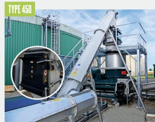
Un système de vis sans fin en deux parties, composé d'une vis sans fin inférieure et d'une vis sans fin inclinée TYPE 450 avec séparateur magnétique, transfère le substrat vers un broyeur vertical.
