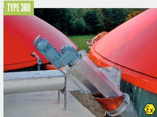
Le système de vis d'alimentation en deux parties TYPE 360, composé d'une vis horizontale et d'une vis de fermenteur selon ATEX, achemine le substrat directement dans le fermenteur.
