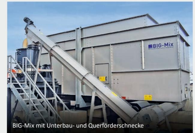
BIG-Mix mit Unterbau- und Querförderschnecke
