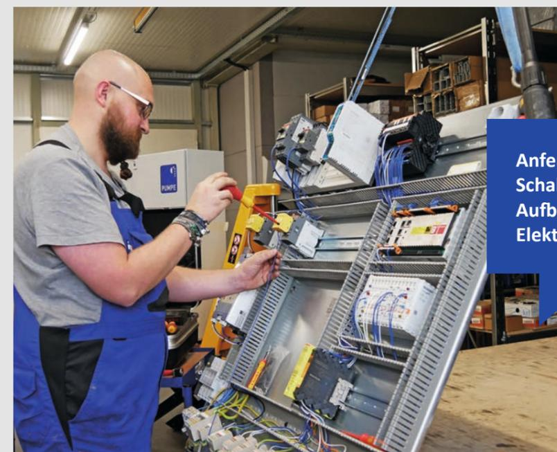
Anfertigung einer neuen Schaltanlage nach Schalt- und Aufbauplan unserer eigenen Elektroabteilung.
