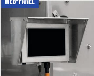
Das Web-Panel ist das Steuerelement der Anlage. Das im Edelstahlgehäuse mit Wetterschutzhaube verbaute Display kann an einer bedienerfreundlichen Stelle am BIG-Mix angebracht und bei Bedarf an weitere Schnittstellen eingebunden werden.
