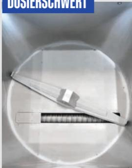
Elementarer Bestandteil des UNI-Dos Raufutter ist die bewährte Bodenentnahme. Im Inneren des Behälters befindet sich ein doppelarmiges Dosierschwert. Dieses rotiert über dem kreisrunden Bodenblech und beschickt eine waagerechte Unterbauschnecke. Die Drehzahl/Fördermenge kann dabei mit einem Frequenzumrichter verändert werden.
