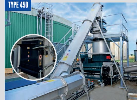
Un système de vis sans fin en deux parties, composé d'une vis sans fin inférieure et d'une vis sans fin inclinée TYPE 450 avec séparateur magnétique, transfère le substrat vers un broyeur vertical.
