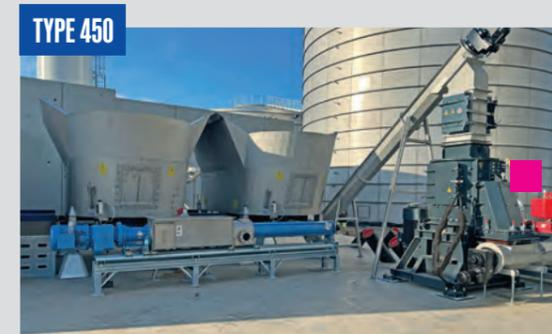
Deux systèmes d'alimentation autonomes alimentent deux systèmes d'alimentation en liquide. L'un d'entre eux achemine le produit vers un broyeur vertical via un système de vis sans fin TYPE 450 en deux parties avec séparateur magnétique. Il est ensuite transporté dans un système d'alimentation en liquide externe à l'aide d'un transfert flexible TYP 450. L'autre est équipé d'une vis sans fin inférieure avec transfert flexible TYP 450, qui transporte dans un système d'alimentation liquide externe.
