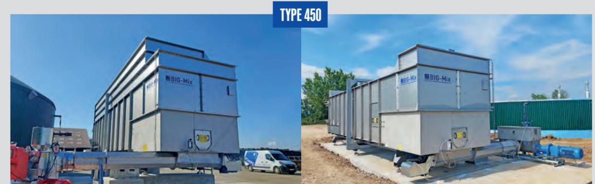
Les vis d'alimentation TYP 450 peuvent être raccordées à tous les systèmes d'alimentation en liquide courants grâce à des transitions flexibles, afin de les alimenter en matières solides de manière fiable et dosée.
