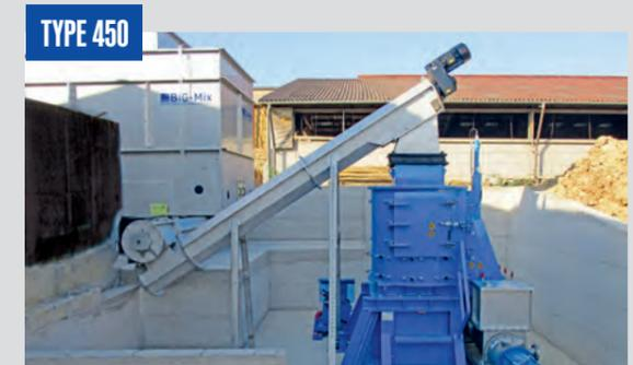
Un système de vis d'alimentation en deux parties TYP 450, composé d'une vis de base et d'une vis d'alimentation inclinée, alimente un broyeur vertical. Le débit d'alimentation est adapté individuellement au niveau de performance du broyeur vertical en aval et au degré de broyage visé.
