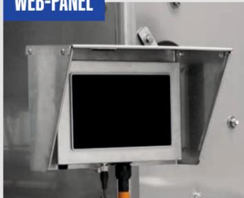
Das Web-Panel ist das Steuerelement der Anlage. Das im Edelstahlgehäuse mit Wetterschutzhaube verbaute Display kann an einer bedienerfreundlichen Stelle am BIG-Mix V angebracht werden und ist bei Bedarf an weitere Schnittstellen einzubinden.
